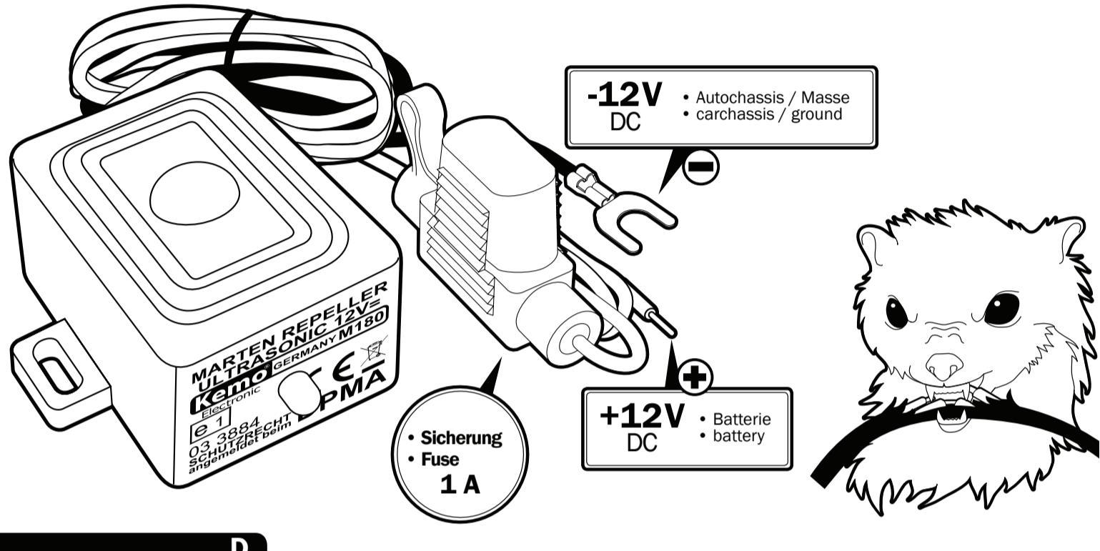
**D** Wenn das Gerät gegen Marder eingesetzt werden soll, dann wird es im Motorraum oder an den Auto-Einstiegslöchern des Marders montiert. Dabei sollte darauf geachtet werden, dass vor der Abstrahlrichtung des Gerätes möglichst viel Freiraum ist, damit sich die Ultraschalltöne möglichst weitläufig im Motorraum ausbreiten können. Den Einbau und die Inbetriebnahme dürfen nur sachkundige Personen vornehmen, die auch die Haftung für eventuelle Schäden übernehmen.
